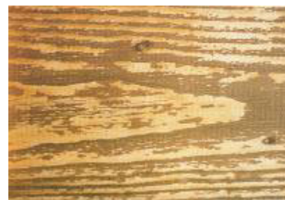
Schichtbildung der KH-Lasuren auf den Hartholz zonen führte bei der Bewitterung zu Ablätterungen (v.a. bei Tangentialschnitten).
