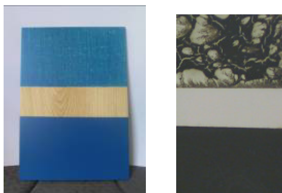
Oberflächenstörung (Refüsieren) in Wasserlacken auf einer PVC-beschichteten Messebauplatte (rechts) und einem mit Wachspolitur behandelten Fichtenholz (links): Behebung der Störung durch Zugabe von 1% Antisilikon ww zum Lack!
