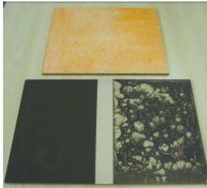
Benetzungsstörung durch Trennmittel bei Acryllackanstrichen auf PVC-beschichteten Messebauplatten (Refüsieren). Behebung mit Antisilikon!
