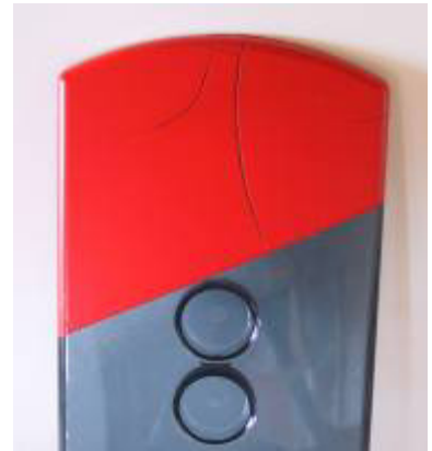
Lösemittelangriff von ATAPUR 2000 auf einem Makrolon-Bauteil!
