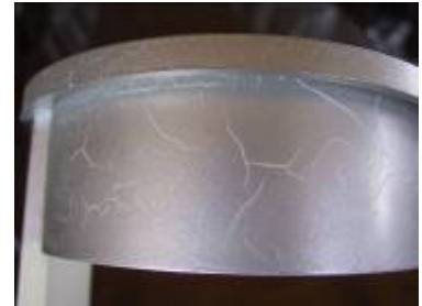
Lösemittelangriff von RUCOPUR Metallisé auf einem Polystyrol-Lampenhalter! auf einem Makrolon-Bauteil!
