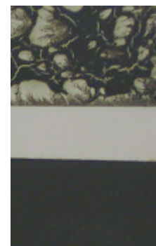
Oberflächenstörung (Refüsieren) in Wasserlacken auf einer PVC-beschichteten Messebauplatte (rechts) und einem mit Wachspolitur behandelten Fichtenholz (links): Behebung der Störung durch Zugabe von 1% Antisilikon wv zum Lack!
